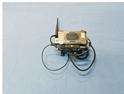
图 6 NVIDIA Jetson Orin NX 边缘计算模块 Fig. 6 NVIDIA Jetson Orin NX edge computing module
